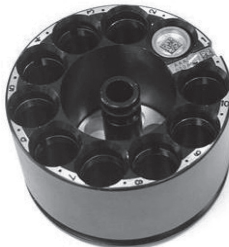
Rysunek 5. Magazynek mieszczący 10 kryształów przeznaczonych do badań używany przez robota ASC. Można załadować 5 takich magazynków.
