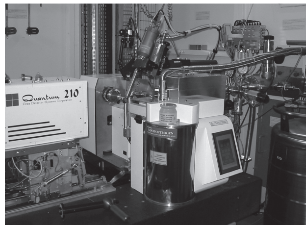
Rysunek 1. Stacja badawcza ID14 (ESRF, Grenoble) do pomiarów dyfrakcji promieniowania rentgenowskiego na kryształach białkowych. Na pierwszym planie widać robot zmieniający próbki wraz z dewarem mieszczącym 50 próbek.
